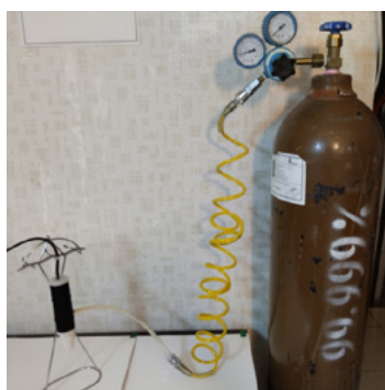
شکل ۳: پلاسما جت و اتصال کپسول گاز هلیوم ۹۹/۹۹ درصد به همراه رگولاتور
