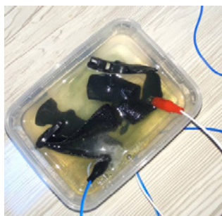
شکل ۲- نحوه الکترولیز کردن الکترودهای خشک استیل و لایه گذاری کردن آنها.
