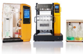
شکل ۶. دستگاه تمام اتوماتیک کلدال
