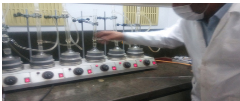
شکل ۳- سیستم هضم نمونه های رسوب (رفلاکس) جهت سنجش عناصر فلزی
