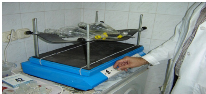
شکل ۲- مراحل استخراج و آماده سازی نمونه های آب جهت اندازه گیری عناصر فلزی
