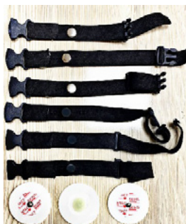
شکل ۱- انواع الکترود ها مرطوب نقره/نقره - الکترود های خشک لایه گذاری شده - الکترود های خشک استیل.
