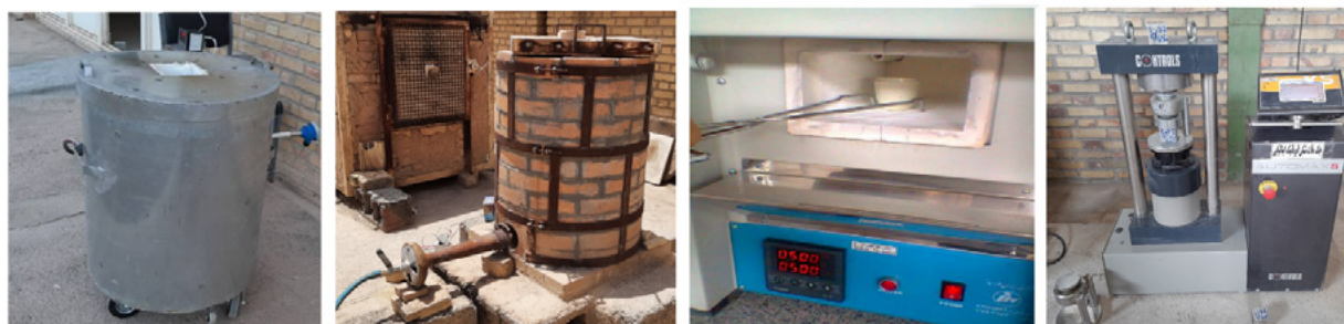
شکل ۲: از راست به چپ: جک ملات شکن مورد استفاده در این پژوهش، کوره الکتریکی، کوره گازی آجری و کوره گازی پرتابل برای بهینه سازی فرآیند تولید خاکستر در ادامه پروژه تحقیقاتی
