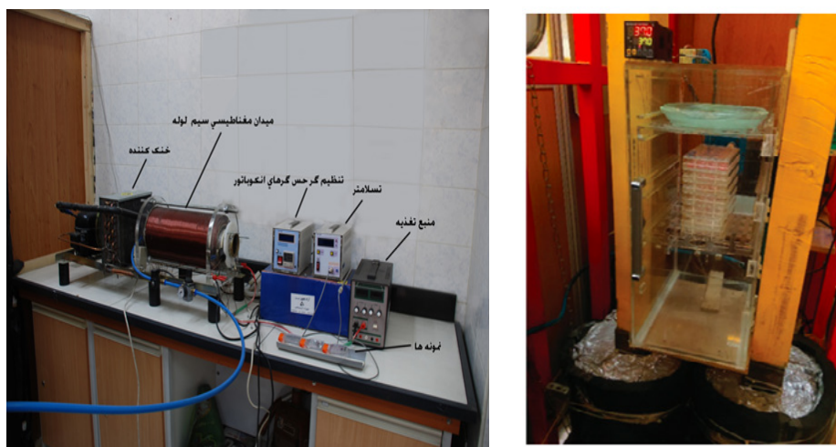
شکل ۳- دو نوع از دستگاه‌های اعمال میدان مغناطیسی ایستا مجهز به انکوباتور که در مطالعات قبلی از آنها استفاده شده است (۱۴،۲۶)
