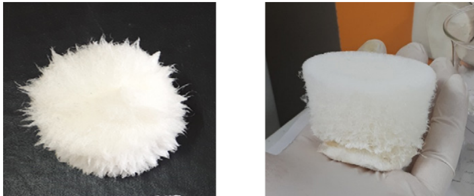
شکل ۵- آیروژل حاصل از روش B_1 (چپ) و روش B_2 (راست)
