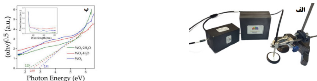
شکل ۲- الف- چیدمان اندازه‌گیری طیف بازتابی آینه ای. ب- طیف جذب نمونه های WO_3 و تعیین نوارگاف نیم رسانا از رابطه تائوک [۳]
