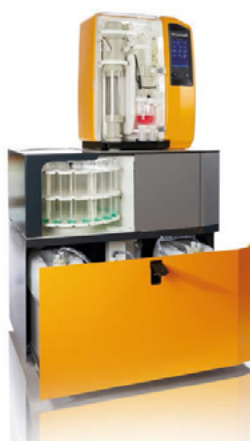
شکل ۷. دستگاه تمام اتوماتیک کلدال با قابلیت آنالیز همزمان ۱۰۰ نمونه و جاگذاری اتوماتیک
