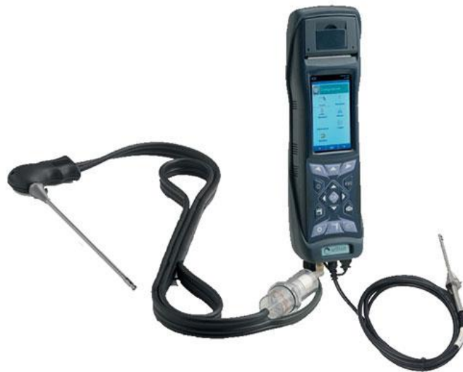
شکل ۱. دستگاه آنالیزور گازهای احتراق برند Seitron مدل Chemist 606S
