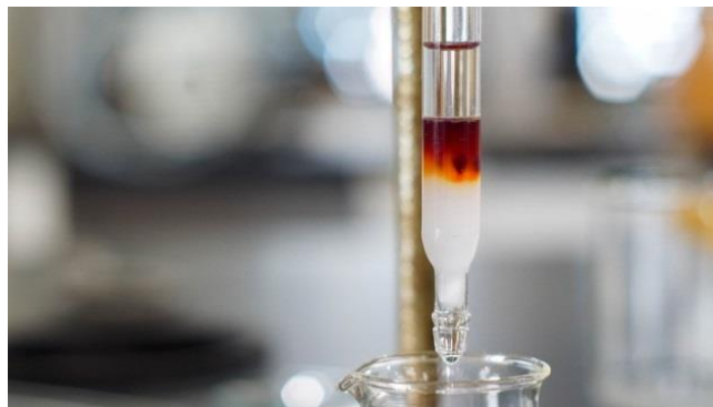
شکل ۱: شمای مربوط به کروماتوگرافی ستونی
