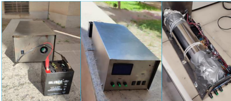
شکل ۱. تصویری از نمای داخلی (اتافک یونش+مدارات الکترونیکی) و نمای بیرونی سیستم آشکارساز طراحی شده.
