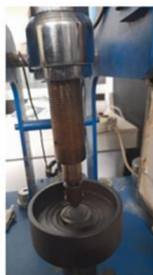
شکل ۱. شماتیک دستگاه پین روی دیسک
