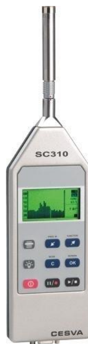
شکل ۱. دستگاه صوت سنج مدل SC310 CESVA
