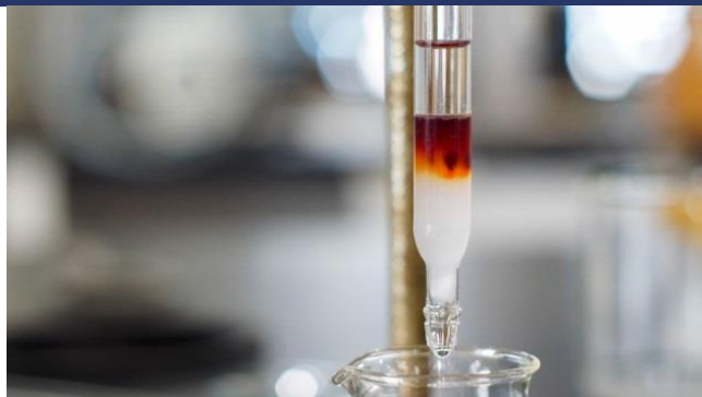
شکل ۱: شمای مربوط به کروماتوگرافی ستونی
