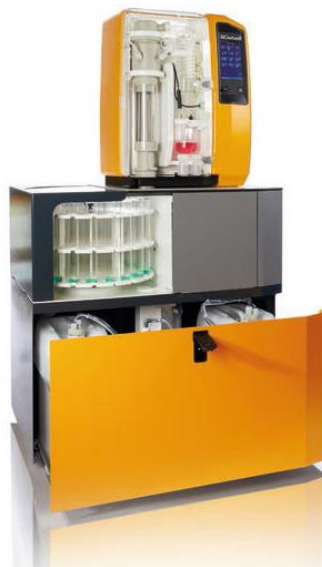
شکل ۷. دستگاه تمام اتوماتیک کج‌دال با قابلیت آنالیز همزمان ۱۰۰ نمونه و جاگذاری اتوماتیک
