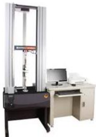
شکل ۵: تصویری از دستگاه اکستنسومتر برای تست مقاومت کششی و پارگی
