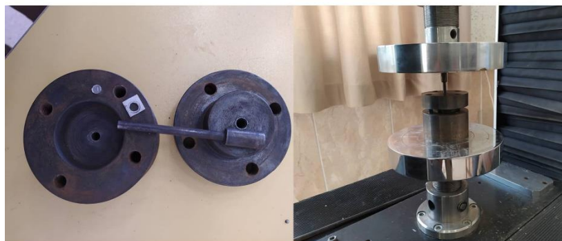
شکل ۶۶: ابعاد طراحی و دستگاه ساخته شده برای آزمون پانچ برشی
