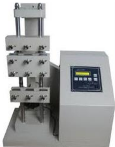
شکل ۱۰: دستگاه خمشی به منظور آزمایش عملکرد ترک خوردگی لاستیک در خمش متناوب
