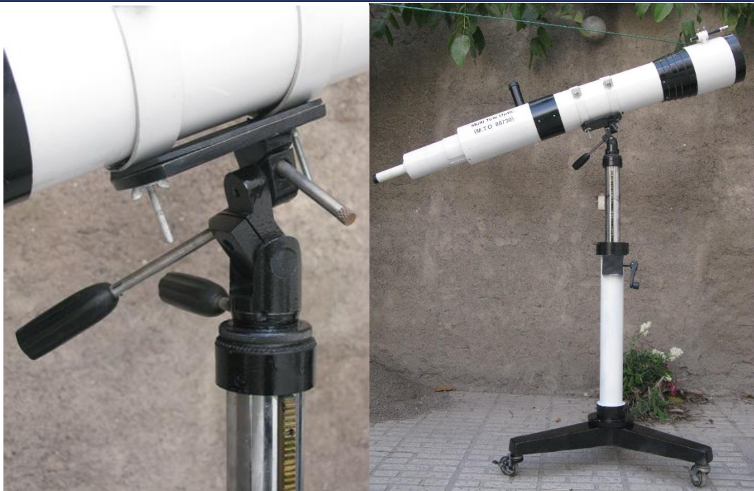
شکل ۴- تصویر تلسکوپ چندمنظوره نجومی (سمت راست) و مقر نگهدارنده لوله اپتیکی تلسکوپ متصل به پایه تلسکوپ (سمت چپ)
