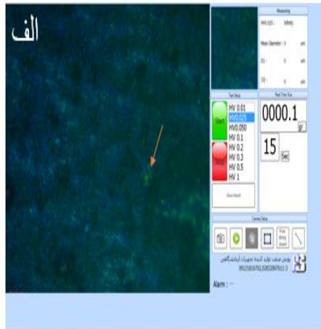
شکل ۸۷. نتایج به دست آمده از تست میکرو سختی سنجی ویکرز (الف): نقطه اثر نیرو (ب): مساحت و سختی پوشش
