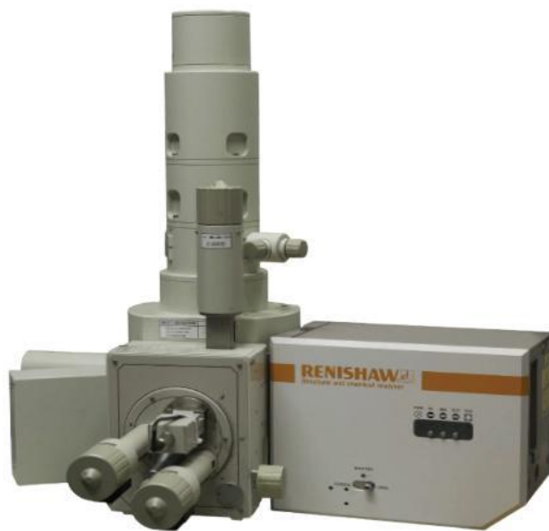
شکل ۱. اسپکتروسکوپی رامان - میکروسکوپ الکترونی روبشی
