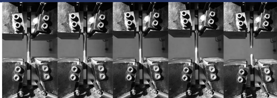
شکل ۶۵: نمونه ای از دستگاه تست کشش تک محوره و روند تغییر شکل در کشش نمونه
