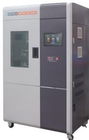
شکل ۷: تصویر دستگاه تست ازن
