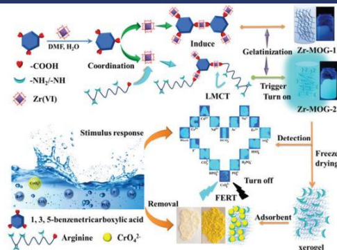
شکل ۶. مراحل تشکیل ژل آلی- فلزی برای پاسخ به محرک و حذف CrO_4^{2-} از آب [۱۸].
