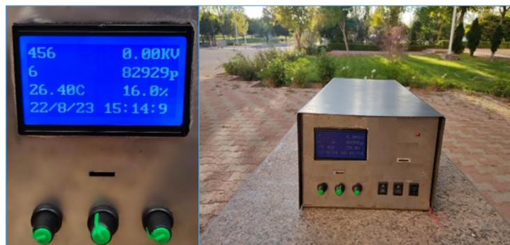
شکل ۱. نمای بیرونی دستگاه اتاقک یونش پالسی مورد استفاده در این پژوهش به همراه تصویری از صفحه نمایش این دستگاه.
