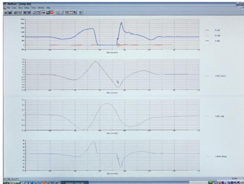
شکل (۵). مثالی از تحلیل نیروهای عکس العمل سطح طی حرکت پرش عمودی توسط نرم افزار BioWare.
