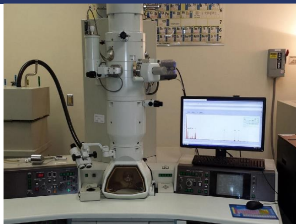
شکل ۷۶: تصویر دستگاه TEM
