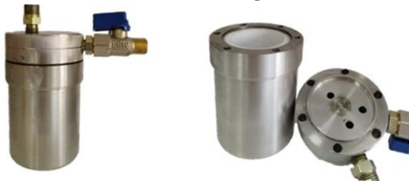
شکل ۱. راکتور طراحی و ساخته شده جهت انجام واکنش تثبیت گاز دی اکسید کربن
