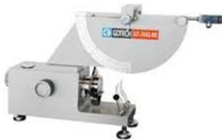
شکل ۱۲: تصویری از دستگاه تست جهندگی
