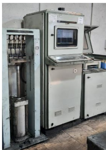
شکل ۱: تصویر نمونه ای از دستگاه مدولاسیون برای بررسی میزان کشش و پخت آمیزه لاستیکی
