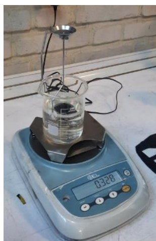
شکل ۱۳: تصویر نمونه ای از ترازو برای تست چگالی آمیزه
