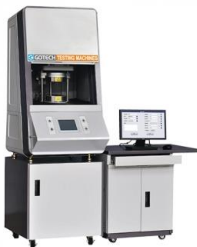
شکل ۴: تصویری از دستگاه تست مونی ویسکوزیته
