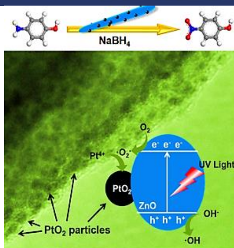
شکل ۸۱: مکانیسم احتمالی کاهش فوتوکاتالیزوری ۴-نیترو فنول با PtO_2/ZnO
