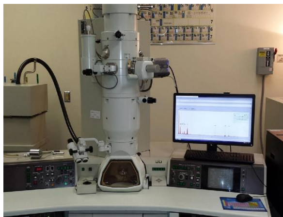
شکل ۱: تصویر دستگاه TEM
