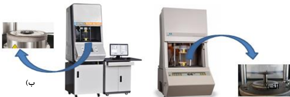
شکل ۲: دستگاه رئومتر الف) با صفحه چرخان و ب) بدون روتور
