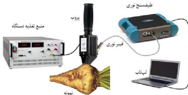
شکل ۱: دستگاه طیف سنج نوری و نحوه چیدمان دستگاه
